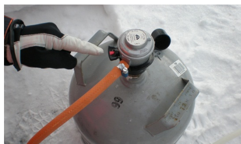
Flaskeventil kobles til og gassventil åpnes
